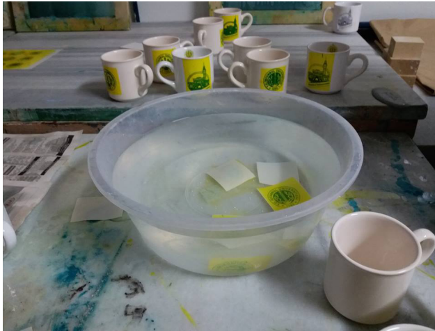
Resim 1. Çıkartma kağıdının ayrılması için suda bekletilmesi
